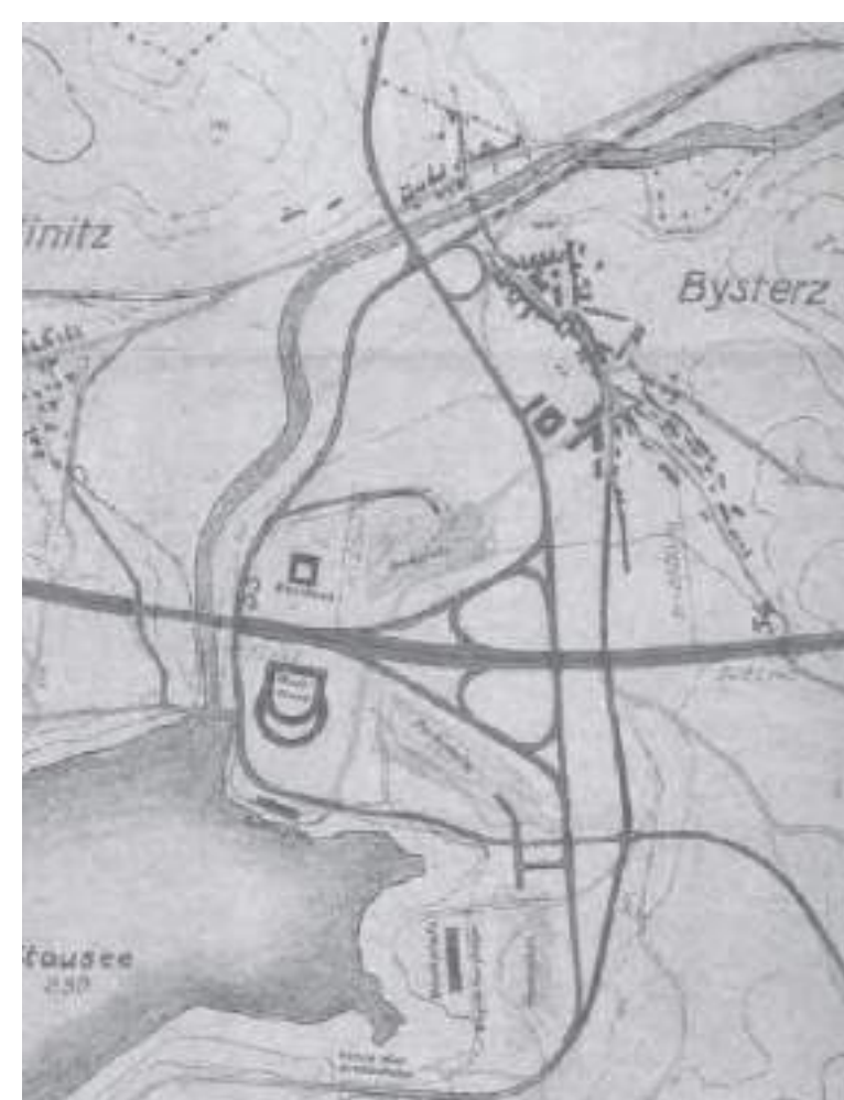
Plán mimoúrovňové křižovatky Brno-sever (1940) Trasa exteritoriální dálnice Vídeň–Vratislav zdroj: Německá průchozí dálnice: II. díl – Jižní úsek, Tomáš Janda, Václav Lidl
