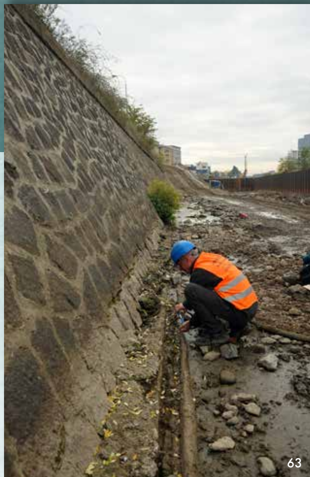
Jedna z dřevěných konstrukcí zpevňující břehy koryta řeky a odběr vzorků na dendrochronologické datování, které na základě analýzy letokruhů umožňuje určit stáří dřeva s přesností na kalendářní rok.
